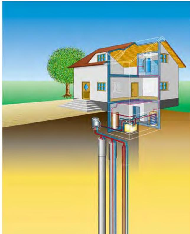
Schema einer Wärmepumpe mit Erdwärmesonden
